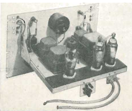
Fig. 10 - Il variatore di potenza adotta un tubo 807 completo di alimentatore, il tutto compreso in una unità meccanica singola.
